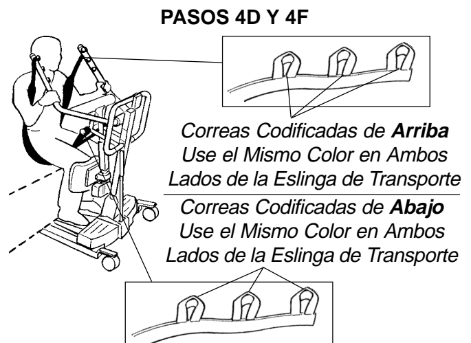
FIGURA 5 – CONECTANDO LAS ESLINGAS AL LEVANTADOR PARA PARARSE ESLINGAS DE TRANSPORTE
